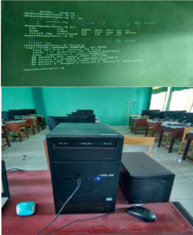
Gambar 6 Server yang dibangun pada SMAN 1 Bandar Baru menggunakan Linux Ubuntu Server 16.04 LTS
