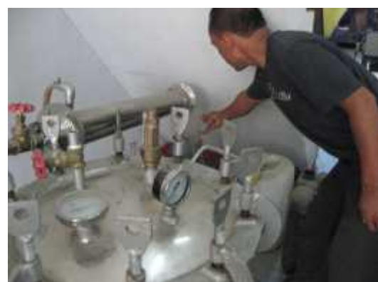
Gambar 3. Praktek desalinasi air payau menggunakan prototype alat desalinasi type distilasi
