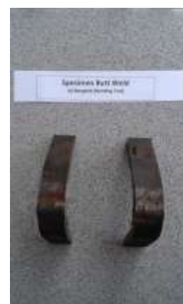
Gambar 8. Hasil pengujian lengkung sambungan las tumpul kampuh V tunggal
