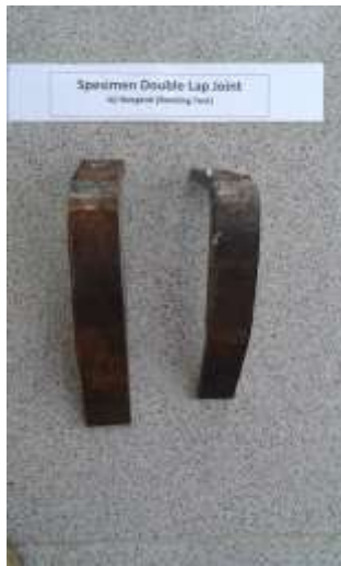
Gambar 9. Hasil pengujian lengkung sambungan tumpang
