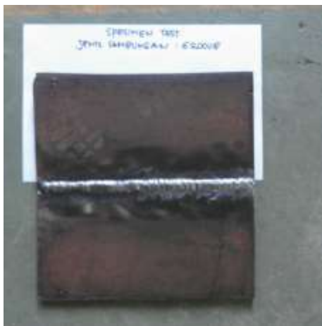
Gambar 5. Sambungan las tumpul kampuh V tunggal
