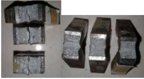
Gambar 5. Foto Makro Dari Spesimen Uji Impak Kelompok Arus 125 Ampere dan 150 Ampere
