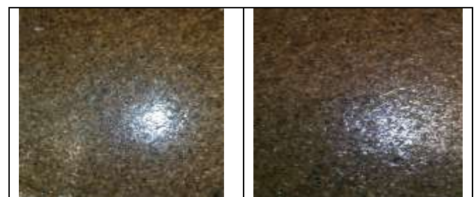
Gambar 6(a). Papan partikel tanpa perekat kulit kopi yang dikempa dengan waktu 15 menit dan suhu 180°C. (b). Papan yang dikempa pada waktu 20 menit dan suhu 200°C.
